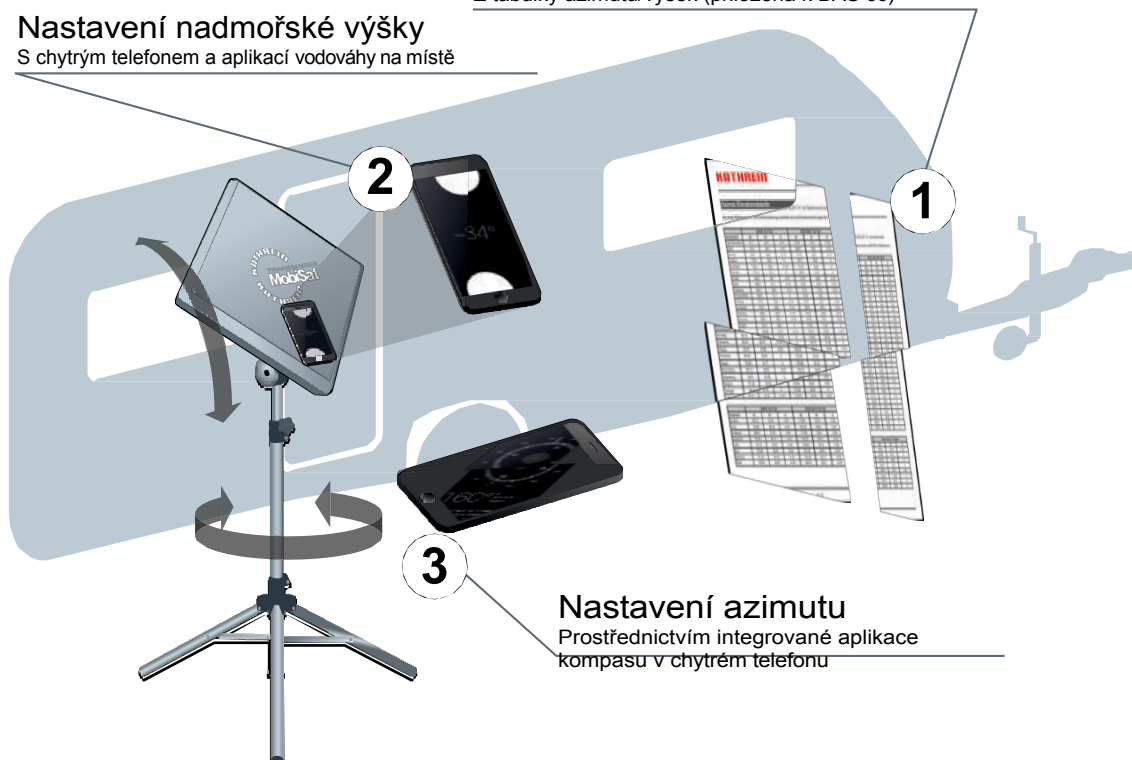
Obr. 7: Nastavení antény HDS 166
