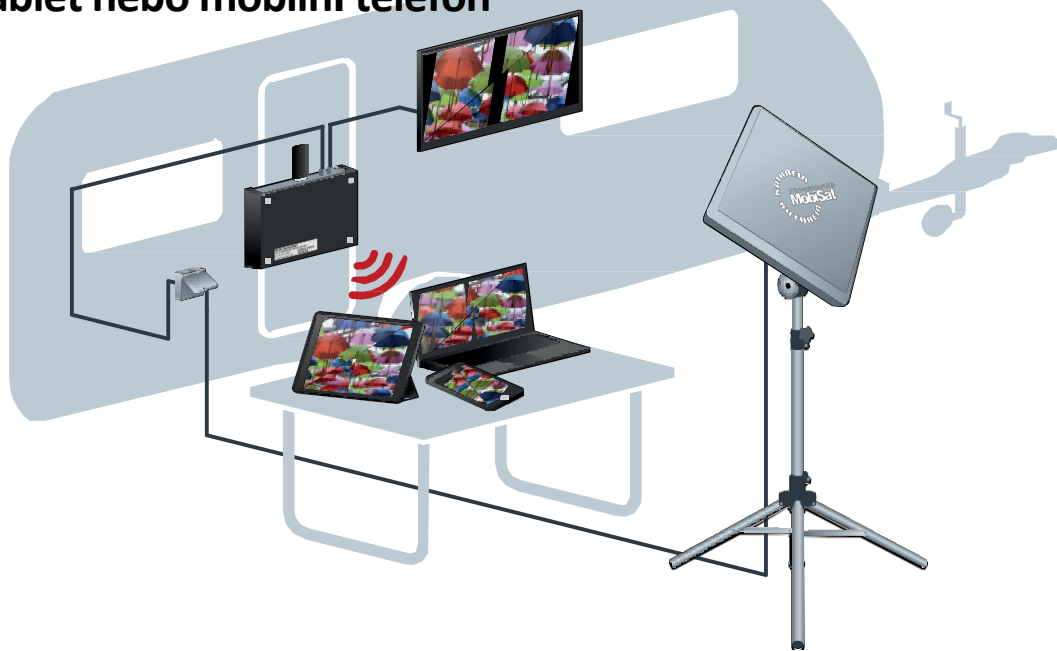
Obr. 10: Živý televizní přenos na mobilních zařízeních s HDS 166 plus
